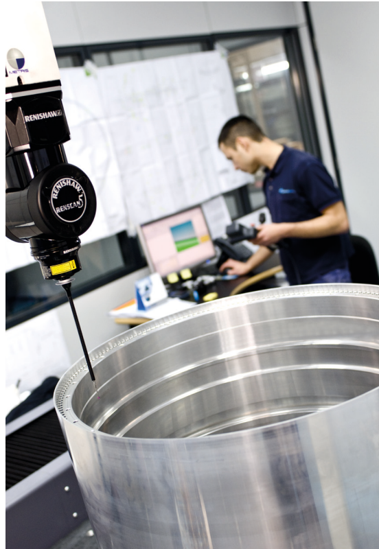
Fallstudie hos Escribano – REVO skannar av ett stort hål på en komponent för flygindustrin
