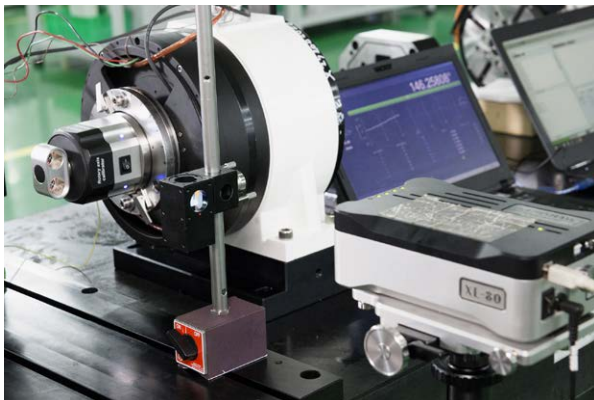
Haozhi utiliza el interferómetro XL-80 y el calibrador de ejes rotatorios XR20-W de Renishaw para inspeccionar sus motores lineales y mesas rotatorias
